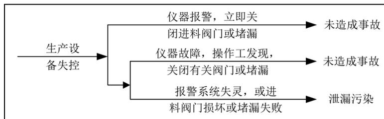
图5-2 生产系统事故树示意图
