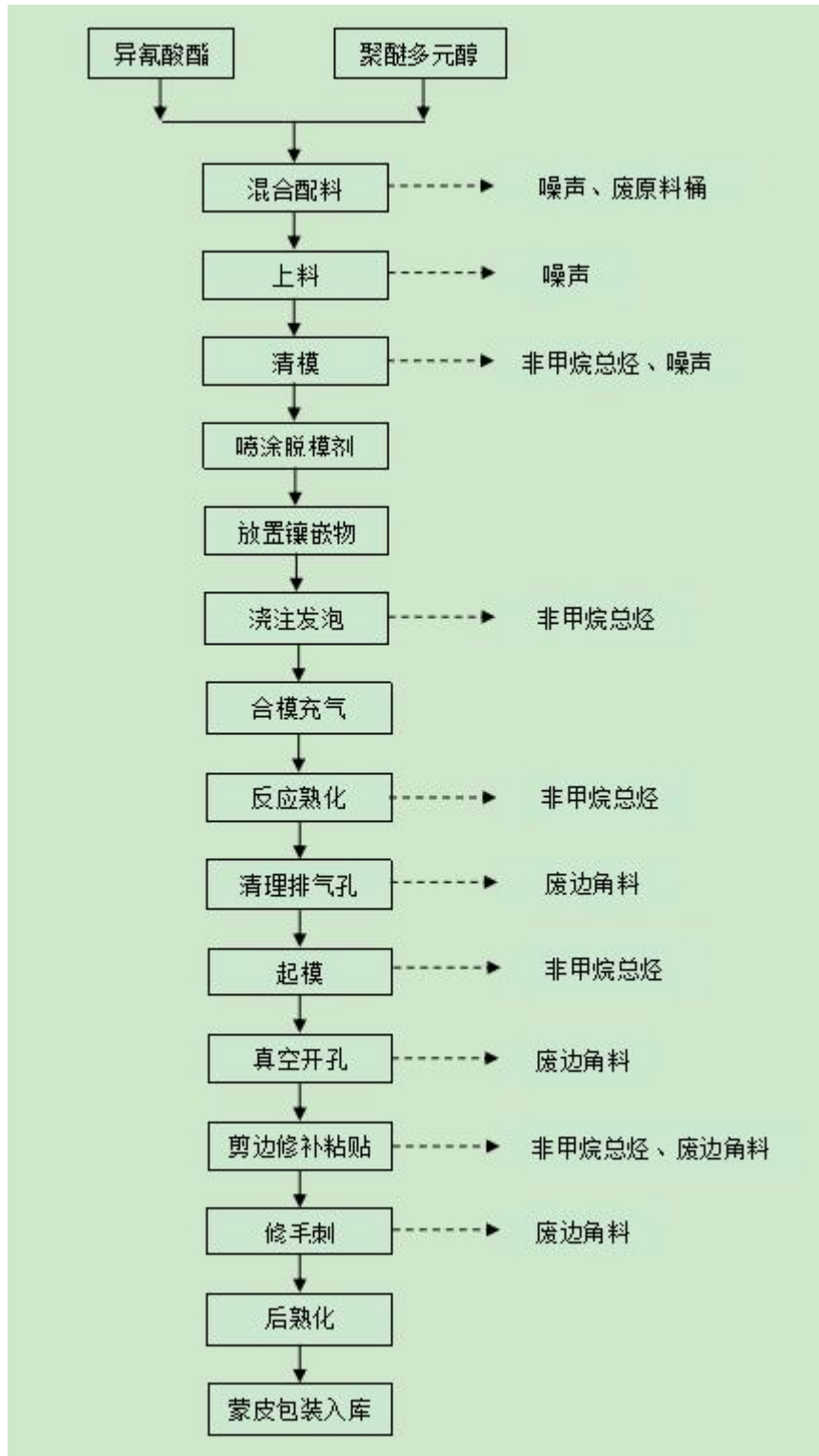
图 4 座椅头枕加工工艺流程及产排污节点图
