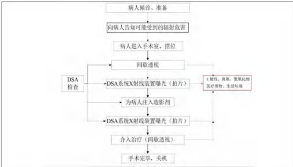
图 9-4 DSA 工作流程及产污环节图
