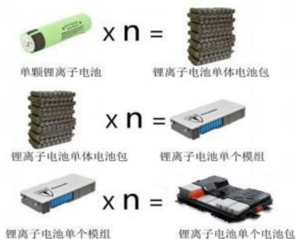
图 4-2 锂离子电池（电池包）构成示意图
