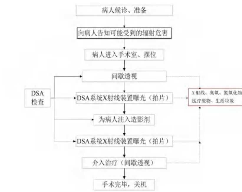
图 9-4 DSA 工作流程及产污环节图
