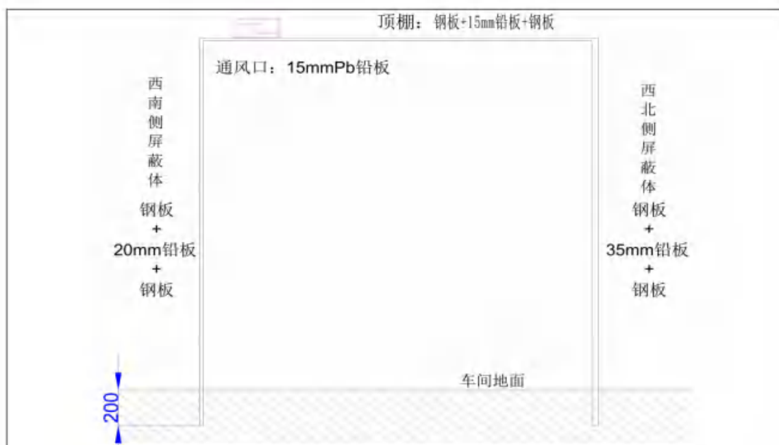
图 10-2 探伤室屏蔽情况剖面图 (a1-a1)
