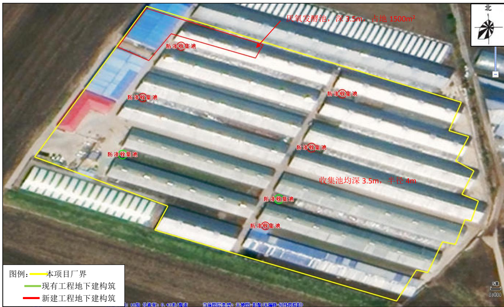
附图 8-2 厂区内地下建筑物平面布置图
